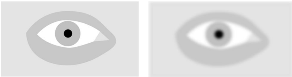
Obrázek 2: Zorné pole termokamery musí správně obsahovat měřený objekt soustředit se. Obrázek vlevo ukazuje správné zaostření, zatímco obrázek vpravo ukazuje neostře obraz.
